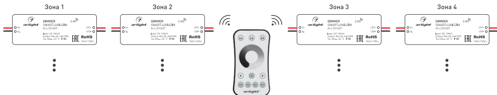
Рисунок 3. Вариант построения системы с 4-зонным пультом дистанционного управления
